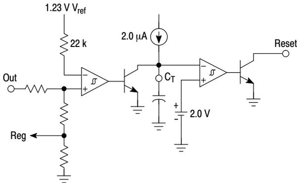
**Figure 18. Reset Circuit**
