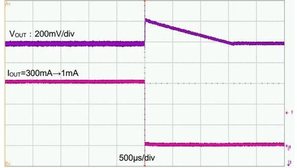
MYRGC075050R/S ( $V_{IN}=12V$ ,  $V_{OUT}=5V$ ,  $I_{OUT}=1mA \rightarrow 300mA$ )
