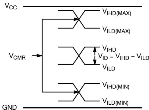
Figure 13.  $V_{CMR}$  Diagram
