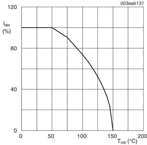
$$V_{GS} \geq 4.5V I_{der} = \frac{I_D}{I_{D(25^\circ C)}} \times 100\%$$
