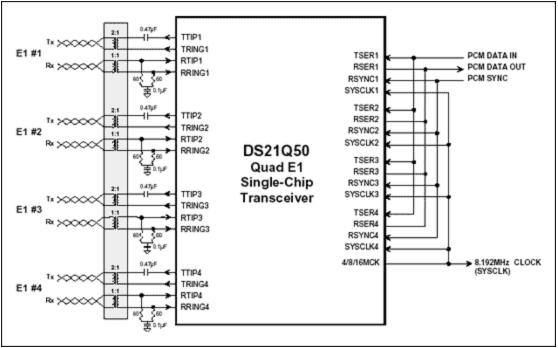
Figure 1. Four port E1 transceiver using DS21Q50.
