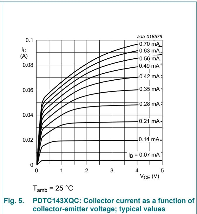
**50 V, 100 mA NPN resistor-equipped transistors**
