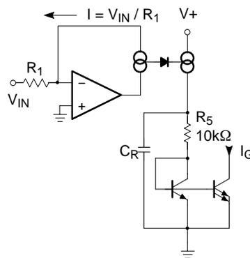
**Figure 8. Rectifier Concept**
