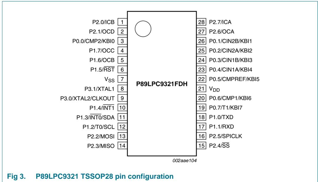
**Fig 3. P89LPC9321 TSSOP28 pin configuration**
