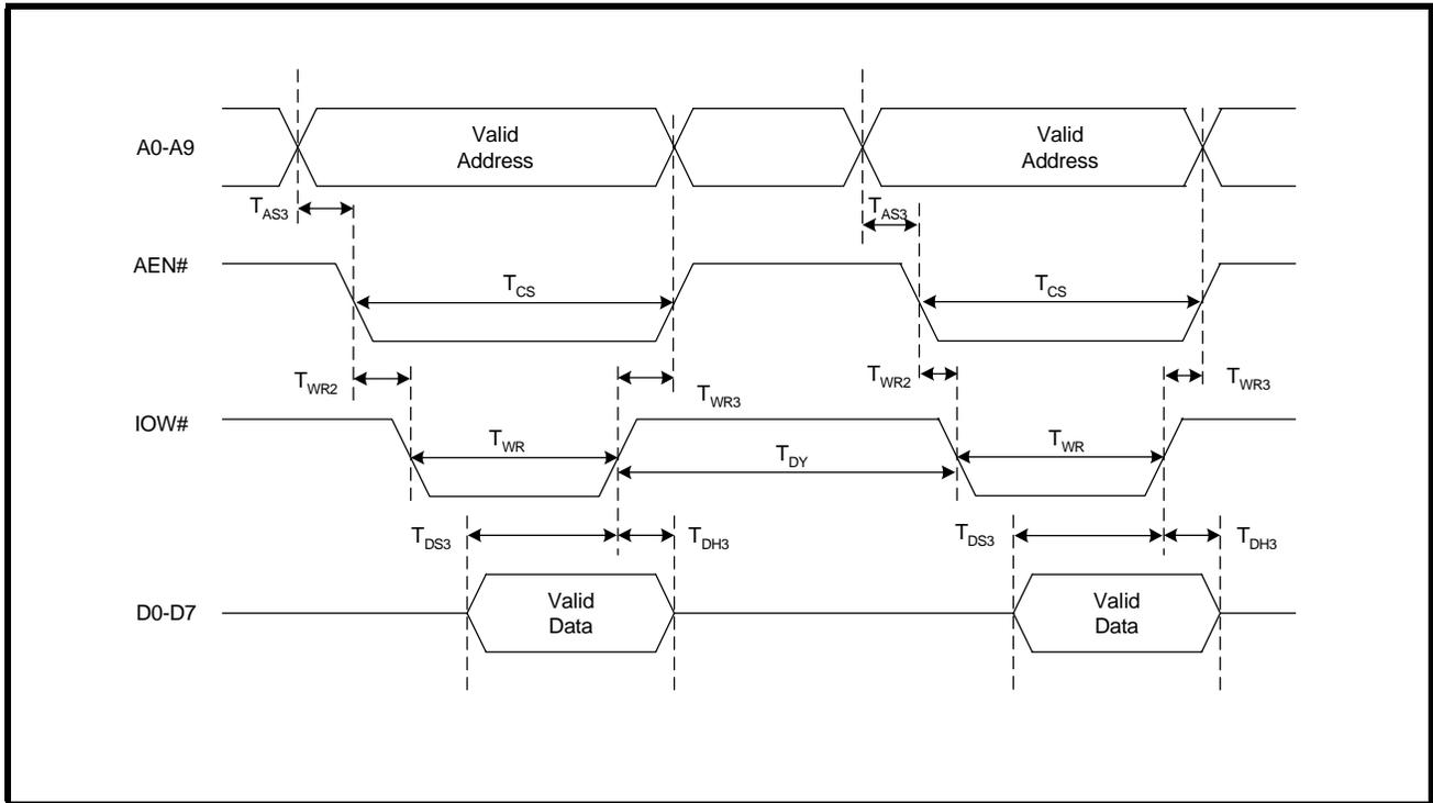
**FIGURE 26. RECEIVE READY & INTERRUPT TIMING [NON-FIFO MODE]**
