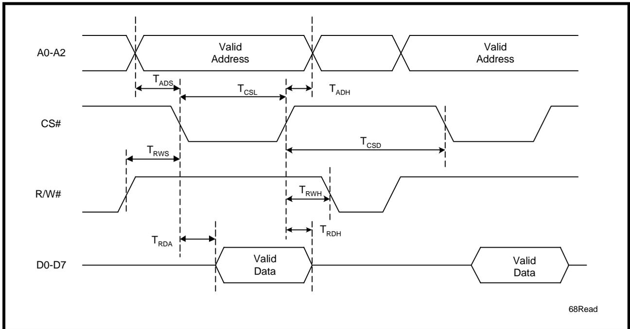
FIGURE 23. 68 MODE (MOTOROLA) DATA BUS WRITE TIMING
