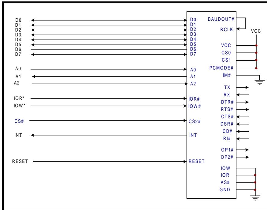
**FIGURE 4. XR16L651 MOTOROLA BUS INTERCONNECTIONS.**
