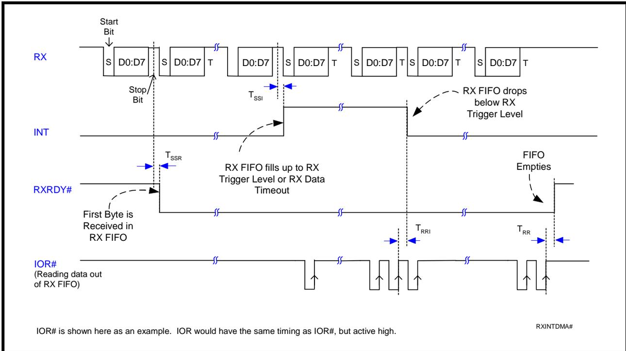
**FIGURE 29. RECEIVE READY & INTERRUPT TIMING [FIFO MODE, DMA ENABLED]**
