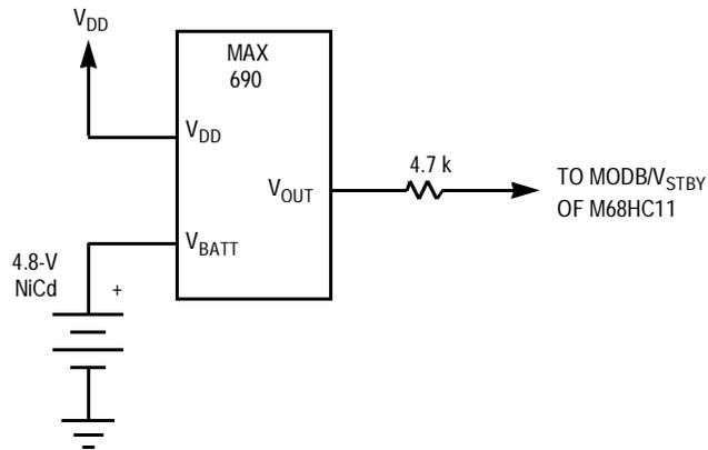
**Figure 4-8. RAM Standby MODB/V<sub>STBY</sub> Connections**
