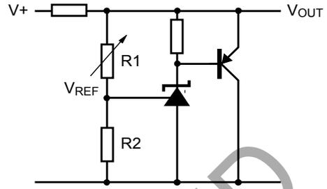
$$V_{OUT} = \left(1 + \frac{R1}{R2}\right) V_{REF}$$
