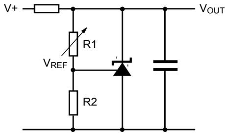
$$V_{OUT} = \left(1 + \frac{R1}{R2}\right) V_{REF}$$
